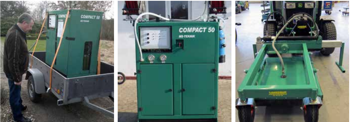
Compact 50 kan transporteres på en trailer eller monteres på en traktor. Compact 50 Dampanlæg med slangeruller, trepunktsophæng og blødgøringspatron (Billedet i midten). Frontmonteret Skærm med hydraulisk sideforskydning (Billedet th.)
